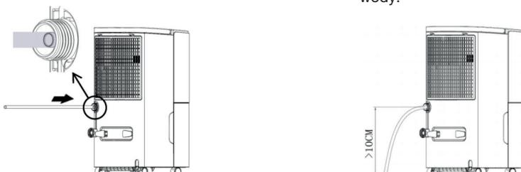
Uwaga: wąż podłączony zewnętrznie nie może znajdować się wyżej niż wylot wody i musi być odpowiednio wyprostowany, w przeciwnym razie istnieje ryzyko wycieku wody.
